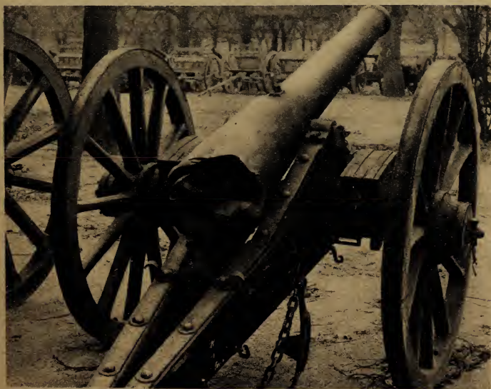
Belgisches Geschütz mit gesprengtem Verschuß.
